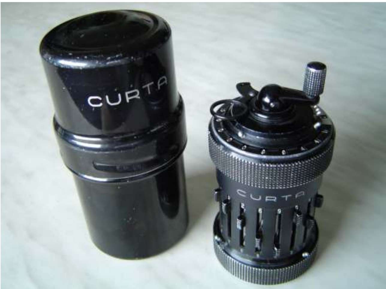
Beispiel einer Staffelwalzen-Rechenmaschine in der technisch brilliant umgesetzten zylindrischen Bauweise der „ CURTA I “
